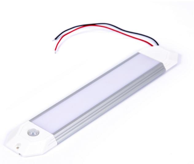
La réglette EM-LED800PIR est dotée d'un **détecteur de présence** qui déclenche l'éclairage dès lors qu'une personne rentre dans l'habitacle. Lorsqu'aucune présence n'est détectée, l'EM-LED800PIR **s'éteindra automatiquement après 2 minutes** ce qui permet d'éviter toute décharge inutile sur la batterie.
